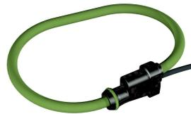
UCT LEM.3 pinzas de intensidad flexibles FLEX 3000 hasta 30 / 300 / 3000A.
